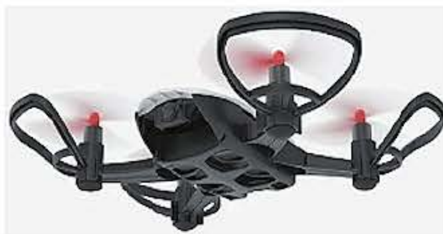
Рис. 7.7. Литой корпус, крышка и защита винтов
