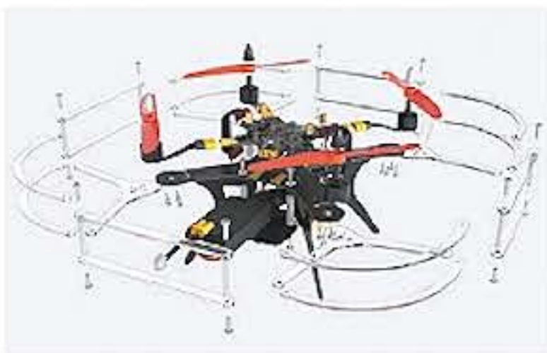
Рис. 7.10. Пример корпусной защиты
