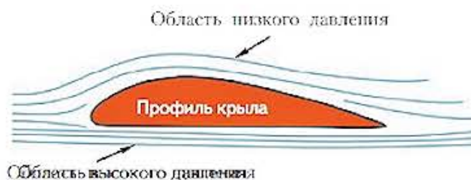
Рис. 5.2. Обтекание крыла потоками воздуха
