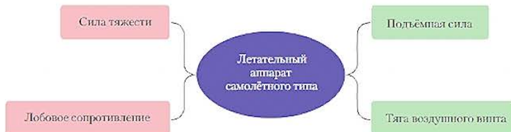
Рис. 5.3. Силы, действующие на летательный аппарат
