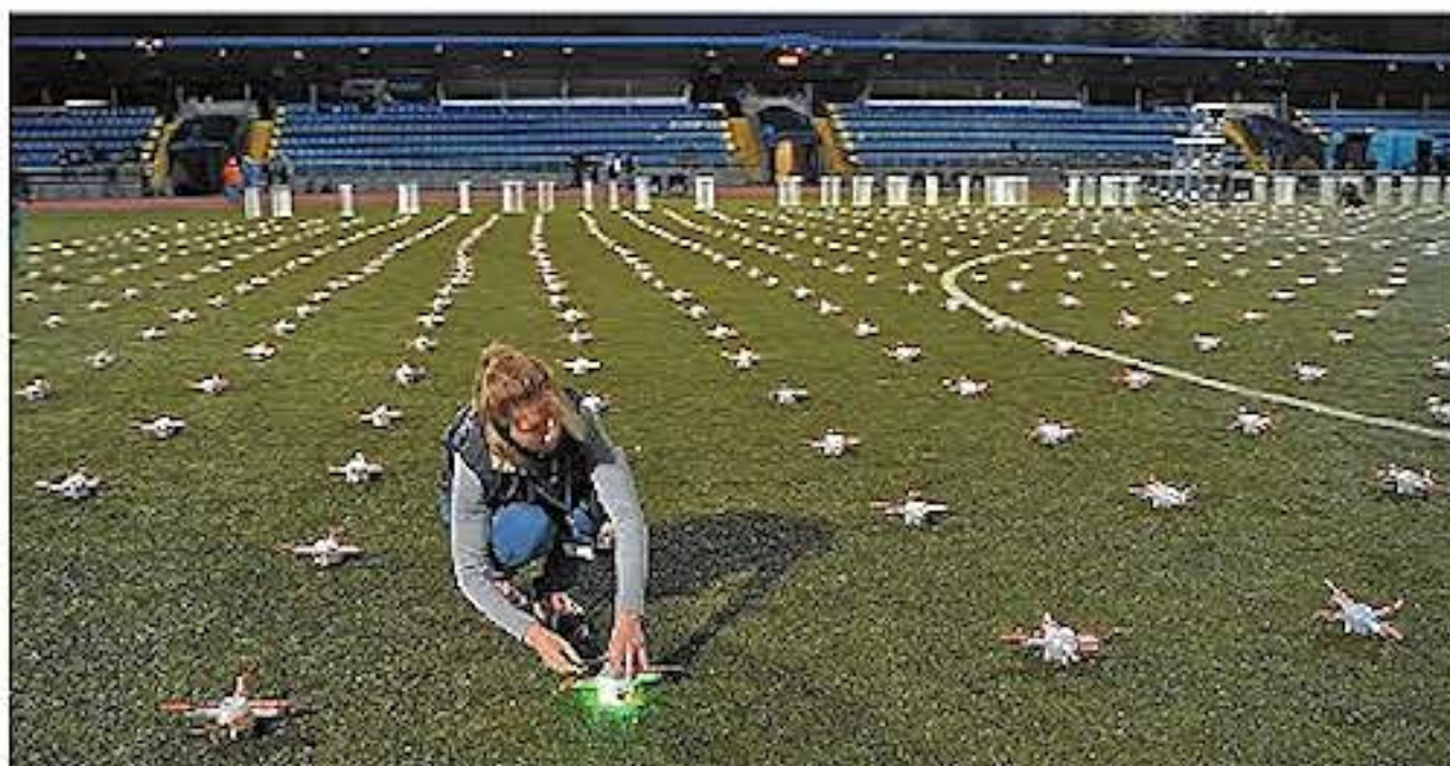
Рис. 16.2. Подготовка роя дронов к запуску, синхронизация со станцией RTK
