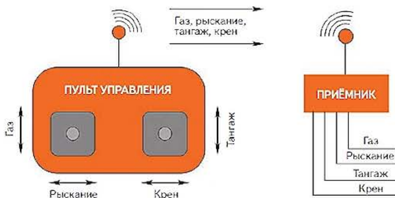
Рис. 11.4. Взаимосвязь передатчика и приёмника
