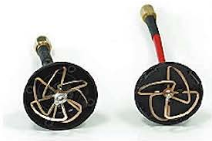
Рис. 11.11. Левая (LHCP) и правая (RHCP) поляризация
