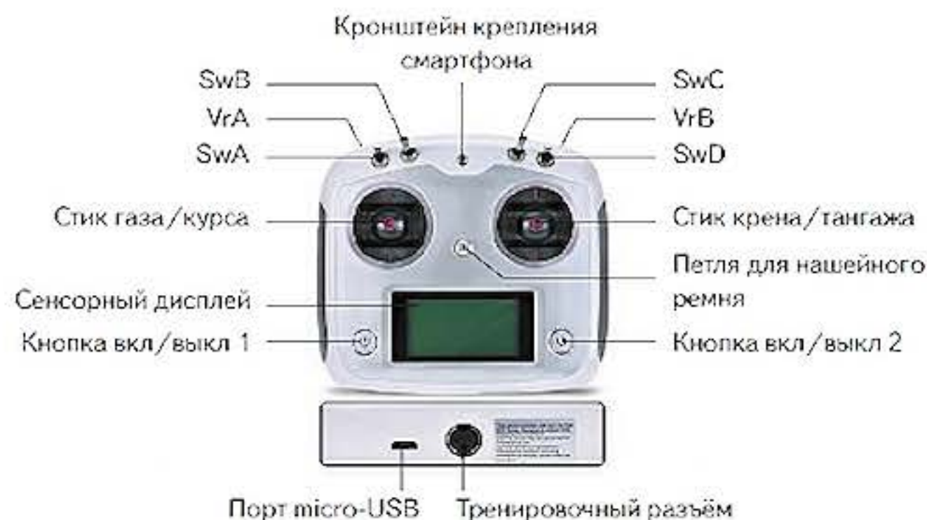
Рис. 14.1. Схема пульта ДУ
