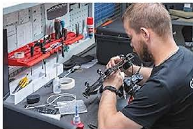
Рис. 21.5. Сборка полезной нагрузки для квадрокоптера
