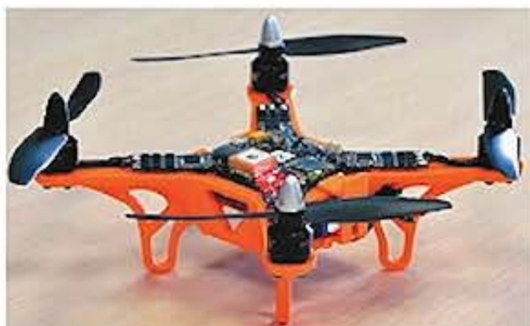
Рис. 7.8. Рама, изготовленная методом 3D-печати
