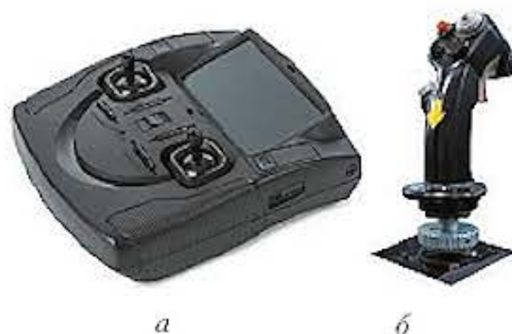
Рис. 11.3. Типы радиоаппаратуры: а — джойстиковый; б — пистолетный
