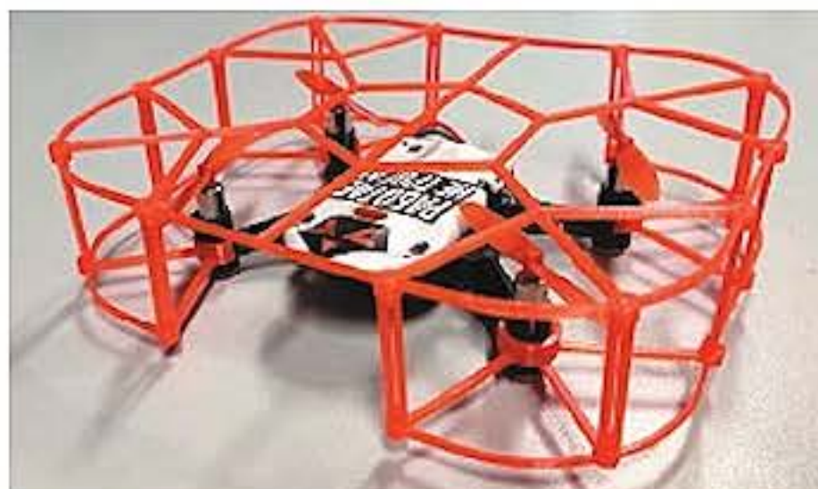
Рис. 7.12. Дрон с клеткой на винтах
